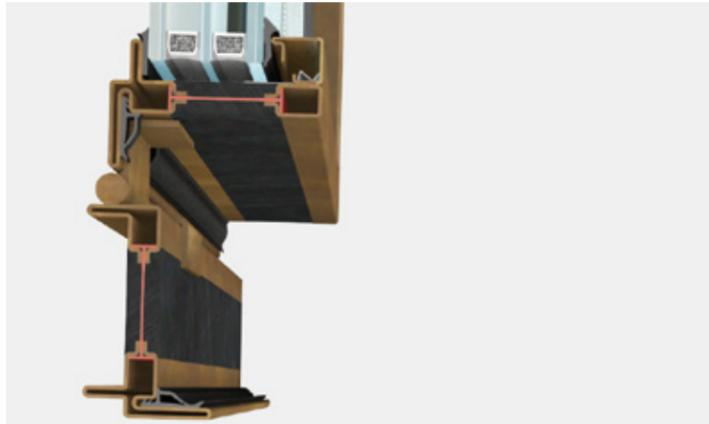
OS2 porte ouverture interne est un système complet d'accessoires, de joints et de profils à rupture de pont thermique de 77 mm de profondeur qui permet de réaliser une large gamme de fenêtres rectangulaires, en forme ou cintrées. Peuvent être installés des verres isolants jusqu'à une épaisseur de 50 mm. Les caractéristiques d'isolation des menuiseries sont assurées par un système à double joint de butée et par un joint à guillotine automatique sous le profilé de base.
