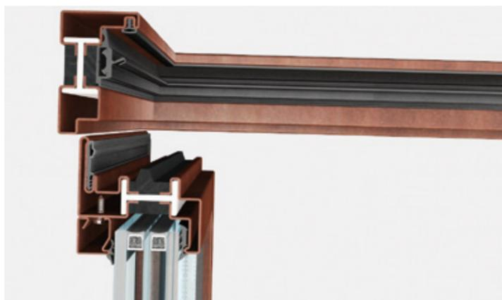
EBE 75 fenêtre est un système intégré d'accessoires, joints et profilés à rupture de pont thermique de 75 mm de profondeur qui permet de réaliser des fenêtres dans une vaste gamme de variantes possibles: carrées, rectangulaires, arrondies ou façonnées et d'installer des verres isolants jusqu'à 48 mm d'épaisseur. Chaque typologie est pourvue d'accessoires spécifiques (escamotables au besoin) intégrés au système.
