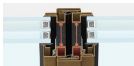
section centrale | section apparente 62 mm
