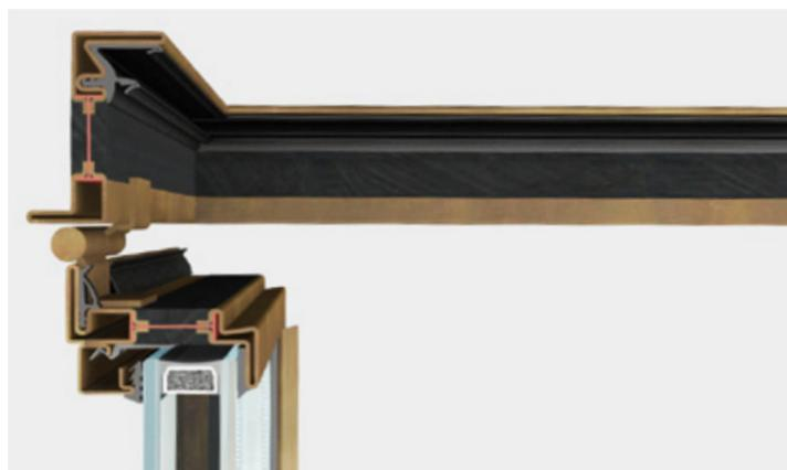
OS2 fenêtre ouverture interne est un système complet d'accessoires, de joints et de profils à rupture de pont thermique de 65 mm de profondeur qui permet de réaliser une large gamme de fenêtres rectangulaires, façonnées ou cintrées. Peuvent être installés des verres isolants jusqu'à une épaisseur de 40 mm. Une série d'accessoires est développée pour équiper chaque typologie gérée par le système.
