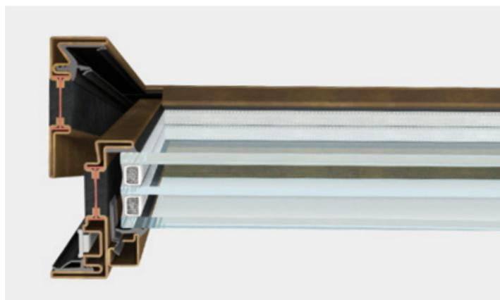
OS2 fenêtre ouverture interne est un système complet d'accessoires, de joints et de profils à rupture de pont thermique de 77 mm de profondeur qui permet de réaliser une large gamme de fenêtres rectangulaires, en forme ou cintrées. Peuvent être installés des verres isolants jusqu'à une épaisseur de 50 mm. Le système prévoit la possibilité d'avoir une ouverture oscillo-battante.
