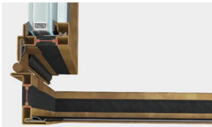
OS2 fenêtre ouverture interne est un système complet d'accessoires, de joints et de profils à rupture de pont thermique de 65 mm de profondeur qui permet de réaliser une large gamme de fenêtres rectangulaires, façonnées ou arrondies. Peuvent être posés des verres isolants jusqu'à une épaisseur de 32 mm. Une série d'accessoires est développée pour équiper chaque typologie gérée par le système.
