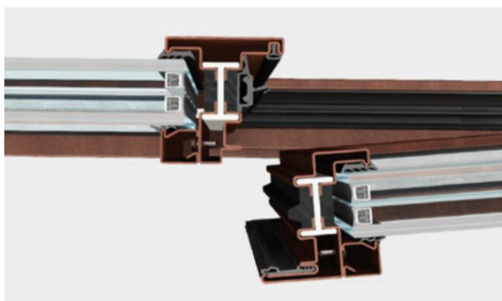
Les caractéristiques d'étanchéité des menuiseries sont assurées par un système de joint ouvert avec trois niveaux d'étanchéité. Les performances du système à rupture de pont thermique EBE 75 ont été testées par les meilleurs laboratoires de certification européens selon les normes de référence EN 14351-1.
