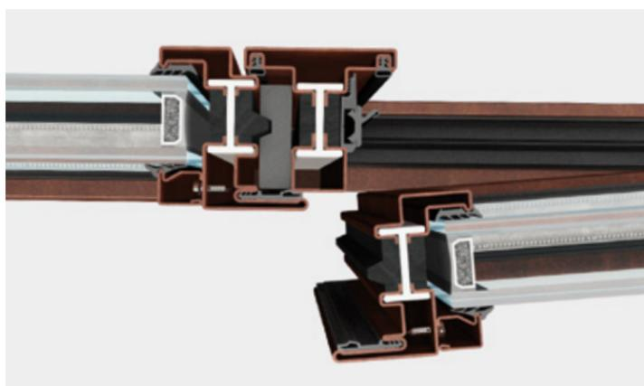
Les caractéristiques d'étanchéité des menuiseries sont assurées par un système de joint ouvert avec trois niveaux d'étanchéité. Les performances du système à rupture de pont thermique EBE 65 ont été testées par les meilleurs laboratoires de certification européens selon les normes de référence EN 14351-1.
