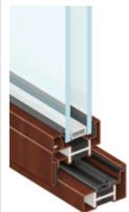
Système EBE à rupture de pont thermique, profondeur 65 mm pour verres jusqu'à 48 mm, saillie interne et coplanarité externe entre vantail et châssis
