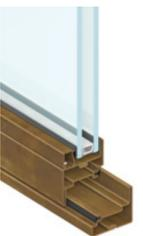
Système de profilés tubulaires avec épaisseur des tôles jusqu'à 1,5 mm, profondeur 55 mm pour verres jusqu'à 40 mm, coplanarité externe et interne entre vantail et châssis
