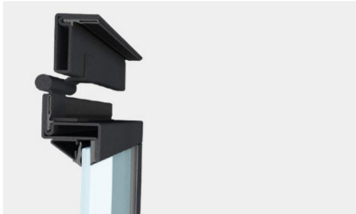
OS2 40 est un système complet d'accessoires, de joints et de profils à rupture de 42 mm de profondeur qui permet de réaliser une large gamme de fenêtres rectangulaires, en forme ou cintrées. Peuvent être installés des verres isolants des vitrages jusqu'à une épaisseur de 27 mm
