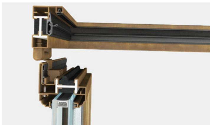
ST 65 fenêtre est un système intégré d'accessoires, joints et profils à rupture de pont thermique disponible en version 65, 75 et 85. ST 65 permet de créer une gamme ample de fenêtres rectangulaires, de formes variées et arrondies et d'installer des vitrages isolants jusqu'à 52 mm d'épaisseur. Chaque typologie est pourvue d'accessoires spécifiques (escamotables au besoin) intégrés au système.
