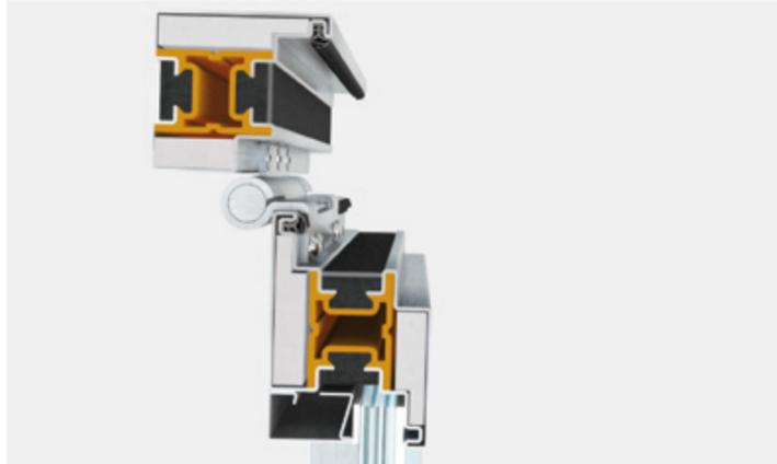
EBE AF est un système complet d'accessoires, de joints et de profilés à rupture de pont thermique d'une profondeur de 65 mm qui permet de réaliser une vaste gamme de portes et de cloisons vitrées résistantes au feu. Peuvent être installés des vitrages simples ou isolants d'une épaisseur allant jusqu'à 40 mm. Chaque typologie est pourvue d'une gamme d'accessoires spécifique certifiée intégrée au système.
