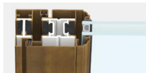
section latérale réduite | section apparente 107 mm
