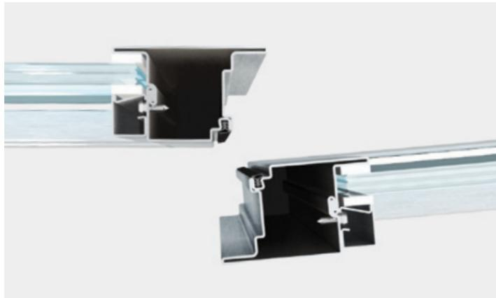
La capacité de la menuiserie à ne pas laisser passer les flammes et la fumée chaude (résistance au feu E) est assurée par la structure du profilé et du système à double joint de butée ; la capacité de contenir l'irradiation hors du côté non exposé aux flammes (irradiation W) est obtenue grâce aux vitrages spéciaux installés. Les performances du système SA AF ont été testées par les meilleurs Laboratoires de Certification Européens selon les normes de référence EN 1634-1.
