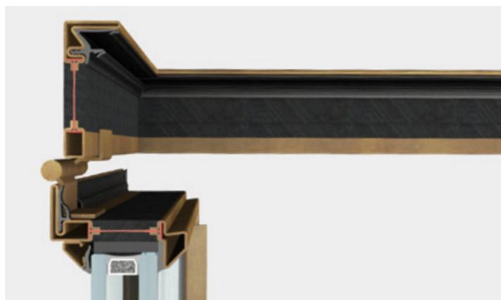
BV fenêtre ouverture interne est un système complet d'accessoires, de joints et de profils à rupture de pont thermique de 77 mm de profondeur qui permet de réaliser une large gamme de fenêtres rectangulaires, façonnées ou cintrées. Peuvent être installés des verres isolants jusqu'à une épaisseur de 40 mm. Une série d'accessoires est développée pour équiper chaque typologie gérée par le système.
