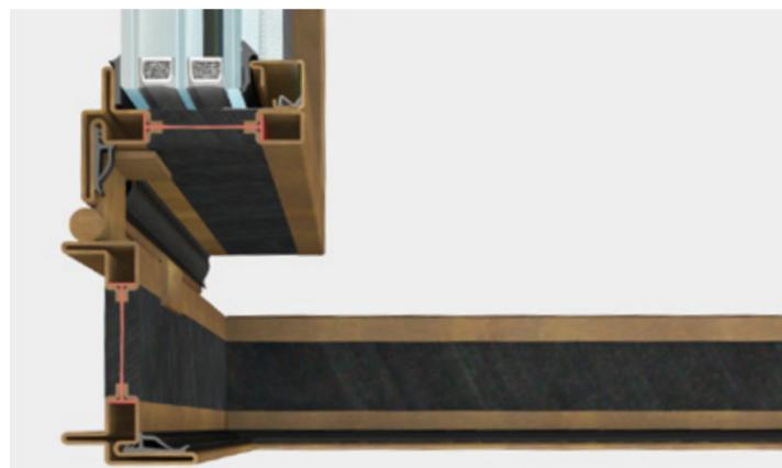
OS2 fenêtre ouverture interne est un système complet d'accessoires, de joints et de profils à rupture de pont thermique de 77 mm de profondeur qui permet de réaliser une large gamme de fenêtres rectangulaires, façonnées ou arrondies. Peuvent être installés des verres isolants jusqu'à une épaisseur de 50 mm. Une série d'accessoires est développée pour équiper chaque typologie permise par le système.
