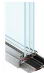
"Menuiserie fine" à rupture de pont thermique pour verres jusqu'à 50 mm, profilés de 27 mm et nœud central 62 mm, ouverture avec oscillo-battant
