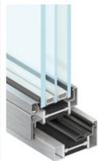
Système EBE à rupture de pont thermique, profondeur 85 mm pour verres jusqu'à 68 mm, saillie interne et coplanarité externe entre vantail et châssis
