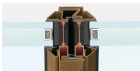
section centrale | section apparente 62 mm
