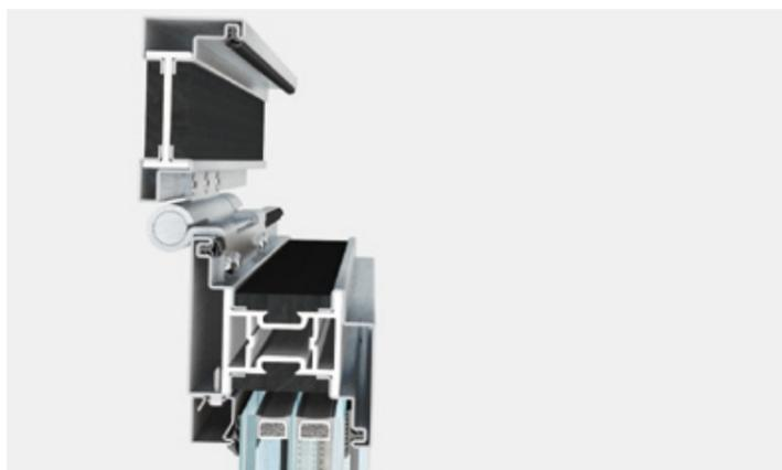
EBE 85 porte est un système complet d'accessoires, de joints et de profilés à rupture de pont thermique ayant une profondeur de 85 mm qui permet de réaliser une large gamme de portes, rectangulaires, en forme ou cintrées. Peuvent être installés des triples vitrages jusqu'à 60 mm d'épaisseur.
