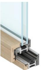
Système ML à rupture de pont thermique, profondeur 65 mm, dans la version avec revêtement interne en bois massif
