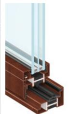
Système EBE à rupture de pont thermique, profondeur 75 mm pour verres jusqu'à 48 mm, coplanarité externe et interne entre vantail et châssis
