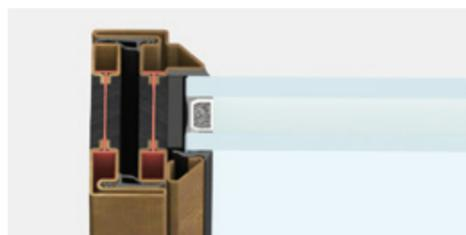
section latérale | section apparente 47 mm
