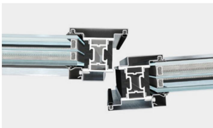
Les caractéristiques d'étanchéité des menuiseries sont assurées par un système à double joint de butée sur trois côtés et par un joint à guillotine automatique sous le profilé de base. Une série d'accessoires est développée pour équiper chaque typologie permise par le système. Les performances du système à rupture de pont thermique EBE 85 ont été testées par les meilleurs laboratoires de certification européens selon les normes de référence EN 14351-1.
