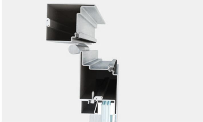
SA AF est un système complet d'accessoires, joints et profilés non isolés thermiquement d'une profondeur de 55 mm et permet de produire une vaste gamme de portes et de cloisons vitrées résistantes au feu. Peuvent être installés des vitrages simples ou isolants d'une épaisseur allant jusqu'à 35 mm. Une série d'accessoires est développée pour équiper chaque typologie permise par le système.
