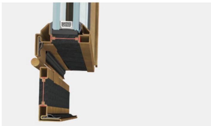
BV porte ouverture interne est un système complet d'accessoires, de joints et de profils à rupture de pont thermique de 77 mm de profondeur qui permet de réaliser une large gamme de fenêtres rectangulaires, en forme ou cintrées. Peuvent être posés des verres isolants jusqu'à une épaisseur de 32 mm. Les caractéristiques d'isolation des menuiseries sont assurées par un système à double joint de butée et par un joint à guillotine automatique sous le profilé de base.
