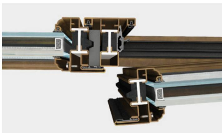
Les caractéristiques d'étanchéité des menuiseries sont garanties par un système de joint central avec trois niveaux d'étanchéité. Les prestations du système à rupture de pont thermique ST 65 ont été testées par les meilleurs Laboratoires de certification européens selon les normes de référence EN 14351 - 1.
