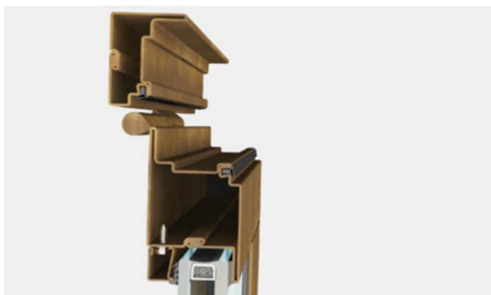
SA 15 porte est un système complet d'accessoires, de joints et de profilés non isolés thermiquement d'une profondeur de 55 mm qui permet de réaliser une large gamme de portes, rectangulaires, en forme ou cintrées. Peuvent être installés des triples vitrages jusqu'à 35 mm d'épaisseur. Les caractéristiques d'étanchéité des menuiseries sont assurées par un double joint de butée sur trois côtés et par un joint à guillotine automatique sous le profilé de base.
