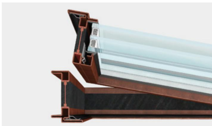
OS2 porte ouverture interne est un système complet d'accessoires, de joints et de profils à rupture de pont thermique de 77 mm de profondeur qui permet de réaliser une large gamme de fenêtres rectangulaires, en forme ou cintrées. Peuvent être installés des verres isolants jusqu'à une épaisseur de 50 mm. Les caractéristiques d'isolation des menuiseries sont assurées par un système à double joint de butée.
