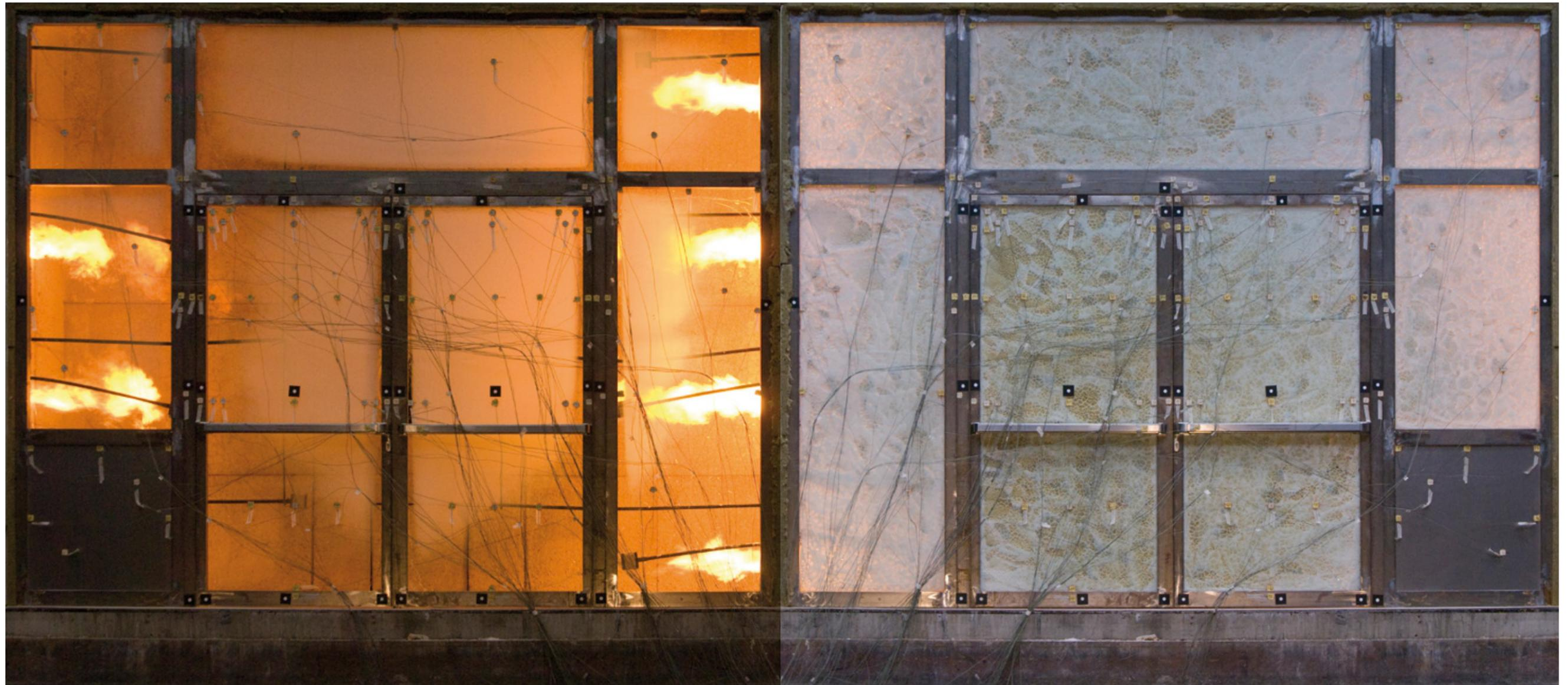
La capacité d'une porte de résister aux très grandes sollicitations causées par un incendie est testée dans des laboratoires spécifiques pourvus d'instrumentation et de fours spéciaux selon des procédures strictement standardisées par la communauté européenne. Le test s'exécute sur un échantillon construit en grandeur nature dans lequel tous les
