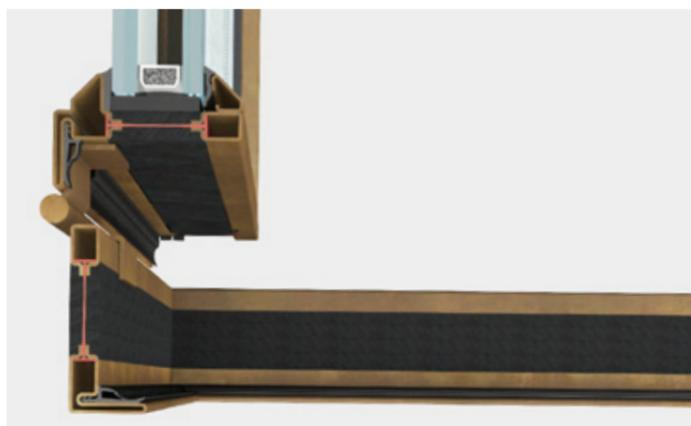
BV fenêtre ouverture interne est un système complet d'accessoires, de joints et de profils à rupture de pont thermique de 77 mm de profondeur qui permet de réaliser une large gamme de fenêtres rectangulaires, façonnées ou arrondies. Peuvent être posés des verres isolants jusqu'à une épaisseur de 32 mm. Une série d'accessoires est développée pour équiper chaque typologie gérée par le système.
