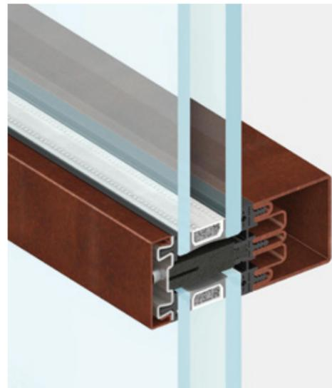
montant/traverse profondeur 50 mm
