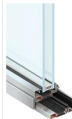
"Menuiserie fine" à rupture de pont thermique pour verres jusqu'à 40 mm, profilés de 27 mm, nœud central 62 mm
