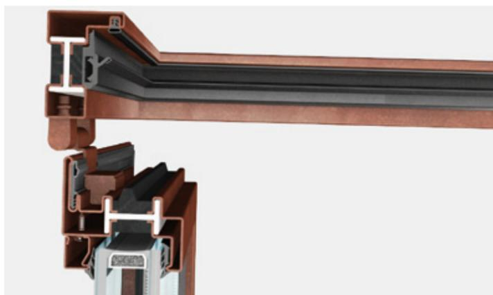
EBE 65 fenêtre est un système complet d'accessoires, de joints et de profilés à rupture de pont thermique ayant une profondeur de 65 ou de 73,5 mm qui permet de réaliser une large gamme de fenêtres rectangulaires, en forme ou cintrées et d'installer des vitrages isolants jusqu'à 46 mm d'épaisseur. Une série d'accessoires est développée pour équiper chaque typologie permise par le système.
