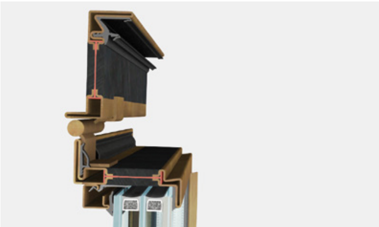
seitlicher Anschluss | Ansichtsbreite 47 mm
