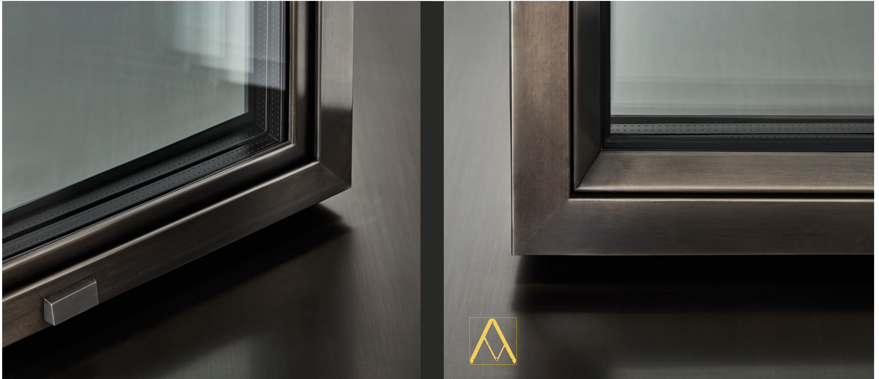
Fensterecke OS2 75 Außenansicht aus brüniertem Edelstahl mit dreieckiger Glasleiste und Stangenscharnier dreigliedrigen Scharnieren.
