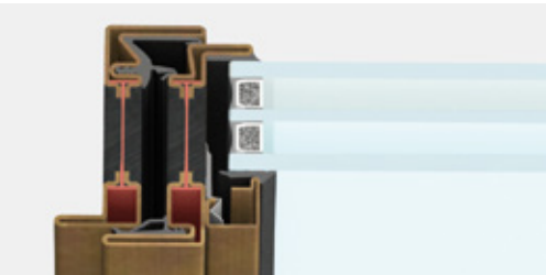
seitlicher Anschluss | Ansichtsbreite 47 mm
