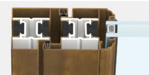
seitlicher Anschluss | Ansichtsbreite 132 mm
