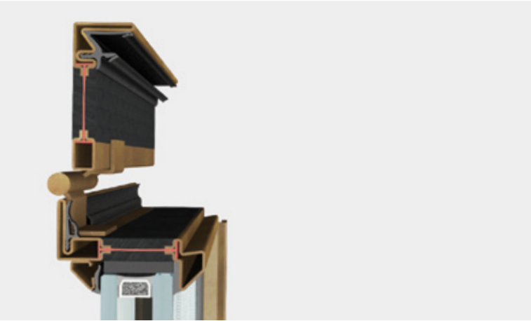
seitlicher Anschluss | Ansichtsbreite 47 mm
