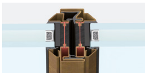
nodo centrale | sezione in vista 62 mm
