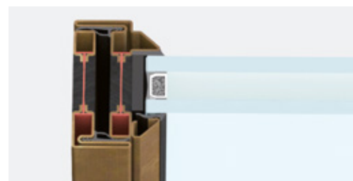
nodo laterale | sezione in vista 47 mm
