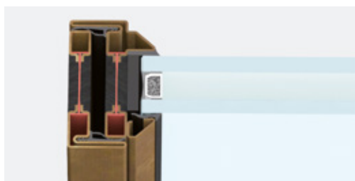
nodo laterale | sezione in vista 47 mm
