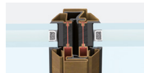
nodo centrale | sezione in vista 62 mm
