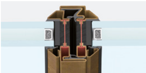
nodo centrale | sezione in vista 62 mm
