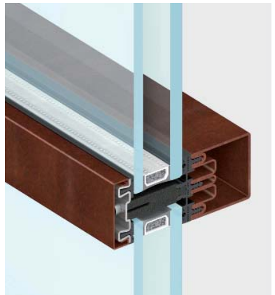
montante/traverso | sezione in vista 50 mm
