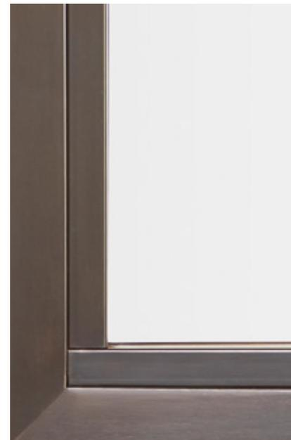
fermavetro rettangolare con fissaggio a scomparsa e giunzione, tra montante e traverso a 90° non saldabile. Disponibile in varie dimensioni per adattarsi ai vetri applicati.
