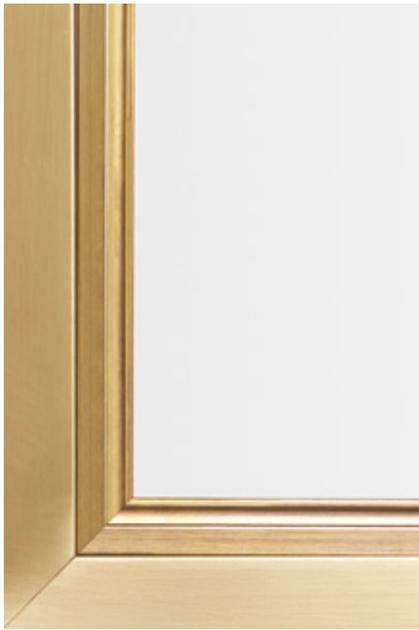
fermavetro rettangolare con modanatura ad incavo. Fissaggio a scomparsa e giunzione, tra montante e traverso, a 45° saldabile.
