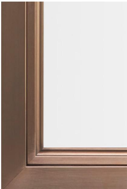
fermavetro modanato in stile gotico con fissaggio a scomparsa e giunzione, tra montante e traverso, a 45° saldabile. Disponibile in due varianti (estruso o profilato) per adattarsi ai vari sistemi.
