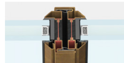
nodo centrale | sezione in vista 62 mm
