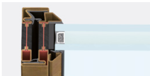
nodo laterale | sezione in vista 47 mm
