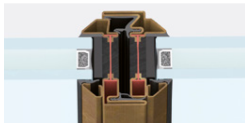
nodo centrale | sezione in vista 62 mm
