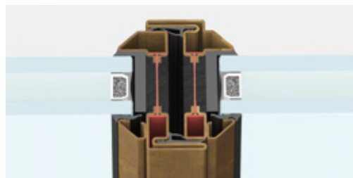
nodo centrale | sezione in vista 62 mm
