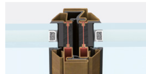
nodo centrale | sezione in vista 62 mm
