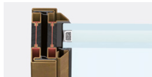
nodo laterale | sezione in vista 47 mm
